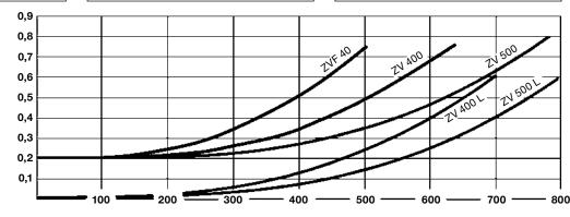
Durchflussleistung (Diesel) Liter/Minute
